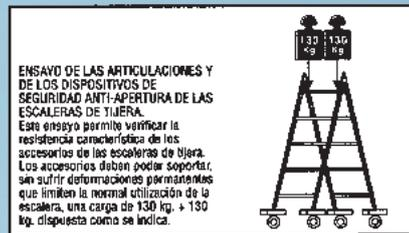
**ENSAYO DE LAS ARTICULACIONES Y DE LOS DISPOSITIVOS DE SEGURIDAD ANTI-APERTURA DE LAS ESCALERAS DE TUBERA.**
