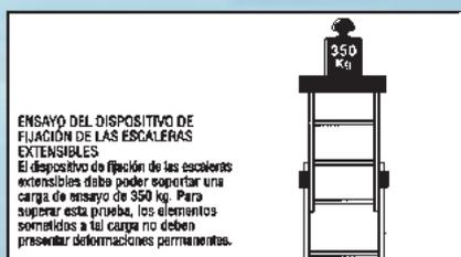
**ENSAYO DEL DISPOSITIVO DE FIJACIÓN DE LAS ESCALERAS EXTENSIBLES**
